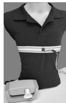
Abb. 1: Gurt mit IMUs zur Bestimmung der Atemfrequenz und Spirometer als Referenzsystem
